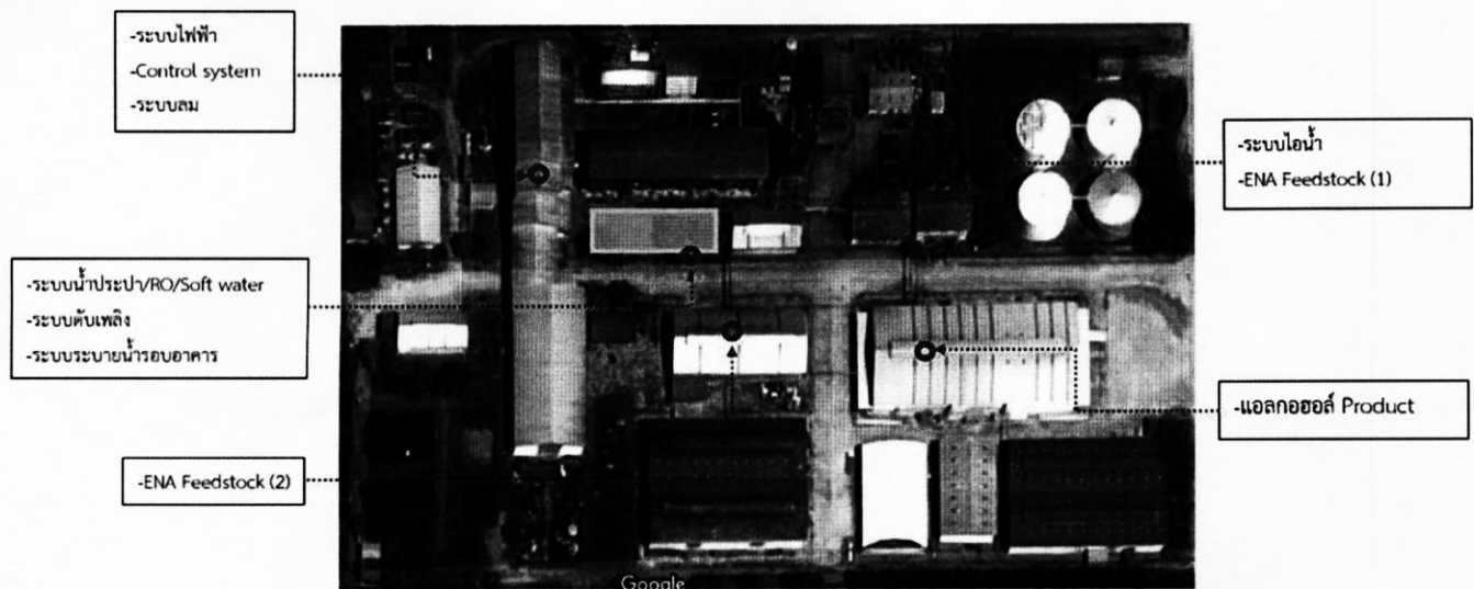
ภาพที่ ๒ แสดงจุดเชื่อมต่ออุปกรณ์สำหรับ Utility และ การรับส่งแอลกอฮอล์ที่ทางองค์การสุราฯ กำหนดไว้
